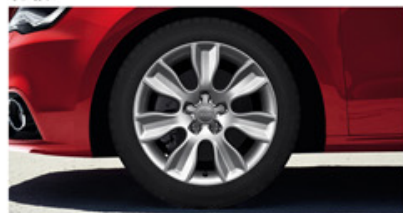
16 英寸铸铝车轮，7 支臂动感造型 尺寸 7 Jx16，配 215/45 R16 轮胎
